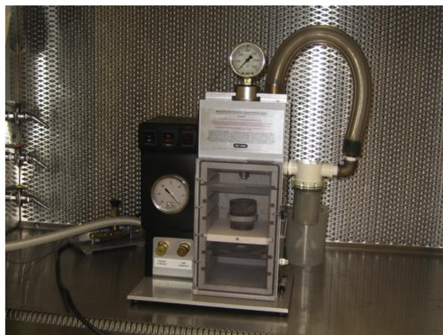
**Figura 1 – Equipo de biolística para transformación de plantas. Foto cortesía A. Castaño.**
